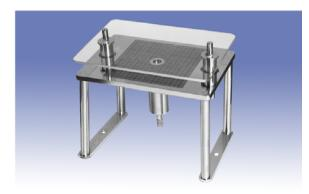
本器はインキ、ペイント、絵の具などの試料の粘性を簡便 に評価するために用いられます。等間隔に刻まれた目盛 板と115gのガラス板との間に試料をはさみ、その広がりの 状態により試料の粘度の比較、「のび」又は「引き」の比較 及び降伏値の測定を行います。従来はこのような試料の 粘度、降伏値の測定には高価な回転粘度計が用いられ ていましたが、安価で比較的精度が良く、操作が簡単で 個人差が少ないことから、試験室は勿論、工場現場など で広くご使用いただいております。
