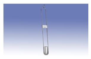
本器はインキ、ペイント、ラッカーなどの粘性の測定に用 いられる最も簡単な比較粘度計です。底部にオリフィスを 有する容量40mLのステンレス製カップに長さ約300mm の柄が付いています。計測は試料が底部のオリフィスを通 して流れ落ちる時間を測定し、その流下時間を下に粘性 を比較します。
